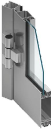
Basissystem für den Einsatz im Inneren von Gebäuden mit geringen Anforderungen an die Wärmedämmung, große Auswahl an Profilen und Zubehör. Auch als rauchdichte Trennwände und Türen in den Klassen Sm und Sa erhältlich, erfüllt die Anforderungen der Norm EN 13502-2:2008.
